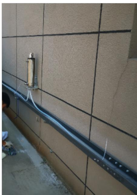
目前市面上的主流静力水准仪，通常可以实现在-30~80℃温度区间内的正常工作。而常规水准测量则会对温度条件比较敏感，较容易受到温度条件的限制。在实际测量工作中，常规的水准测量方式，一方面是水准仪、水准尺、尺垫等设备会因温度的变化产生变形。另一方面是测量人员也无法在极低或极高温度条件下正常的开展测量工作。静力水准仪各部件的组装、连接较为简便，通常只需用连接管把贮液罐和各测点连接起来，然后从一端液罐注入调好的连通液，再经过简单的调试及设置，即可完成静力水准仪的布设工作。压差式静力水准仪通常使用扩散硅压力传感器实现压力测量的。上海压差式静力水准仪厂家
