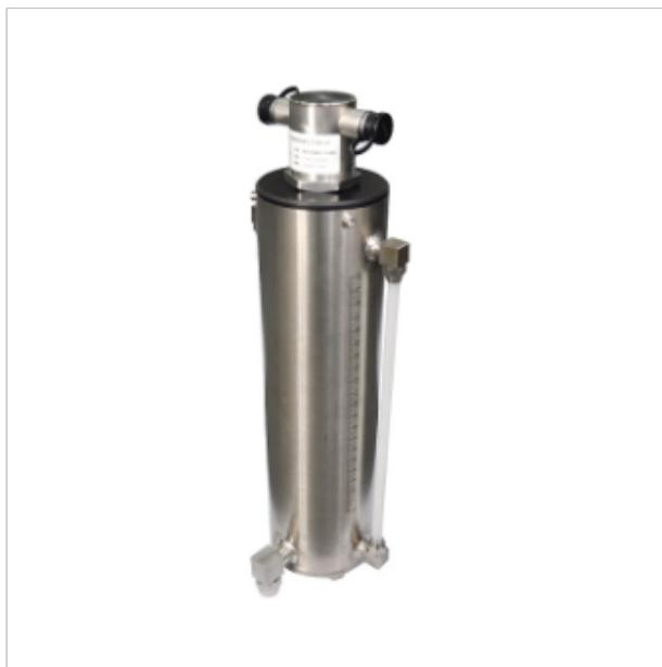
静力水准仪之所以存在多种不同原理、不同类型，一方面是成本原因，但更重要的是每种类型的仪器各有优缺点，即便是基于相同测量原理的不同厂家的监测仪器也存在制作和设计上的不同，在选购时应结合具体类型的监测仪从原理角度入手分析，必要时还需要进行一些简单测试。要了解监测仪是否具有物理液位修正为表征液位的功能以及性能如何。简单的判断方法是厂家是否允许加注多种不同的液体，以及针对每种液体的“温度-密度”特性专业的改正参数，如果号称具有修正功能，但没有供用户输入修正数的参数，基本认为厂家的话不可信。测试是较有说服力的证据，简单的测试方法是注入相同高差但温度不同的液体，观察水准仪的读数，若读数无变化或变化与理论值不符则说明未进行表征液位修正。对于利用浮子或浮力来测量液位的一类静力水准仪，需要了解其是如何解决浮子与内部其它构件接触摩擦力的。可以测试监测仪在非水平放置时的测量灵敏度(一般不水平时浮子摩擦力会增大，导致液位变化时浮子灵敏度下降)。上海压差式静力水准仪厂家通常情况下磁致伸缩式静力水准仪和电容式静力水准仪相对比较便宜些。
