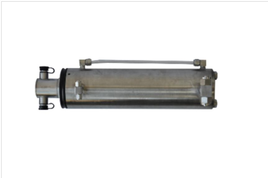
静力水准仪系统在使过程中，一系列的传感器容器使用通液管连接，其中注入一定量的液体，保证所有容器中的液体可以自由流动，利用连通液的原理，多支通过连通管连接在一起的储液罐的液面总是在同一水平面，即保持相同的高度，但是各个容器中的液体深度并不相同，这也就反映了各个容器所在的各个参考点的高度的不同。当容器液位发生变化时即被传感器感应，通过测量不通储液罐的液面高度，经过计算可以得出各个静力水准仪仪的相对差异沉降。希望以上的一些相关介绍能够帮助到你。
